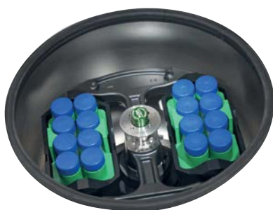
Rotor swing-out H-Flex 1, 90°, R max 170 mm
