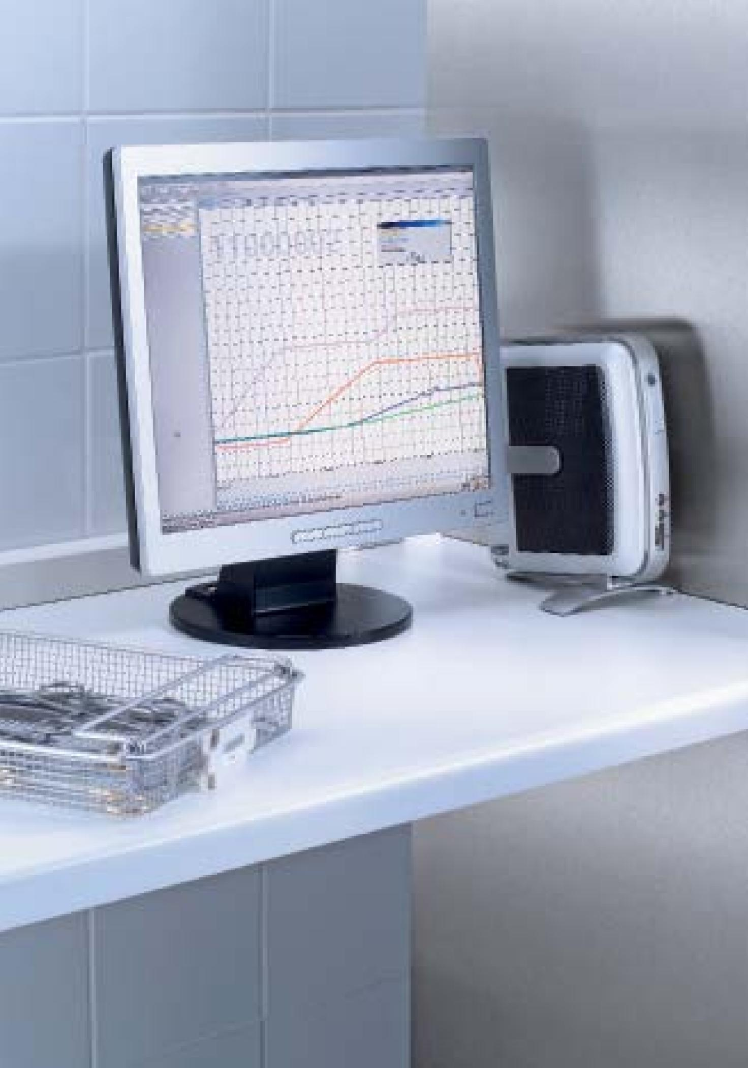
La NetBox.2 est un système complet de traçabilité avec un logiciel pré-configuré. Le système est relié par une interface au laveur-désinfecteur.
