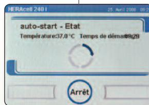
Effectue un étalonnage automatique de toutes les fonctions de mesure électronique et de régulation.
