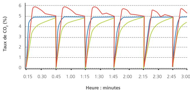
Le recours à une sonde de CO<sub>2</sub> calibrée et à un logiciel élaboré assure un recouvrement rapide du CO<sub>2</sub> sans dépassement. Cela assure une concentration uniforme en CO<sub>2</sub>, même en cas d'ouvertures fréquentes des portes. \*De même, le recouvrement de la température et de l'humidité relative est deux fois plus rapide que sur des incubateurs classiques
