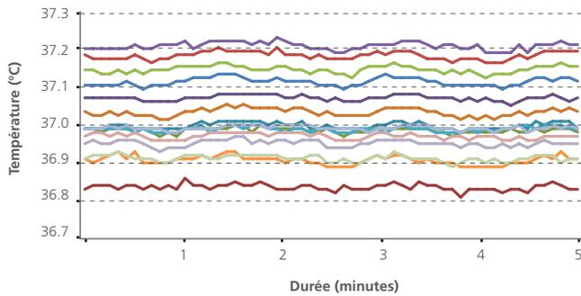
Les différentes courbes représentent les températures mesurées en divers points de l'enceinte. L'homogénéité des températures des incubateurs CelCulture Esco est inférieure à  $\pm 0,2$  °C, ce qui signifie que tous les échantillons de l'enceinte sont soumis à une température uniforme.
