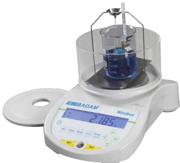
Ce kit vous permet d'utiliser votre balance pour la détermination de densité, et peut être installé sur votre produit. Le kit comprend un thermomètre pour mesurer la température du liquide utilisé, un bécher, des supports et un assemblage de plateau de rechange pour mesurer l'échantillon dans le liquide et dans l'air.
