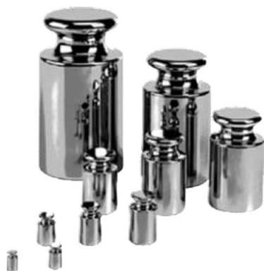
Les coffrets de masses OIML se composent d'un ensemble complet de masses de test qui peuvent répondre aux exigences relatives aux essais selon les normes OIML. La masse E2 offre la plus grande précision idéale pour l'analyse, les masses F1 sont orientés vers les balances de précision et les masses M1 offrent la précision la plus faible mais sont plus abordables et conviennent pour les produits à moindre coût comme les balances compactes et les balances de comptoir.
